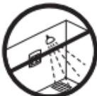
Der Thermostat darf nicht in direkt feuchten Bereichen (Zonen 0, 1 und 2) installiert werden. Beachten Sie stets die örtlichen Vorschriften bezüglich der IP-Schutzklassen. Dies bedeutet jedoch nicht, dass die Thermostate nicht in Badezimmern installiert werden können.
